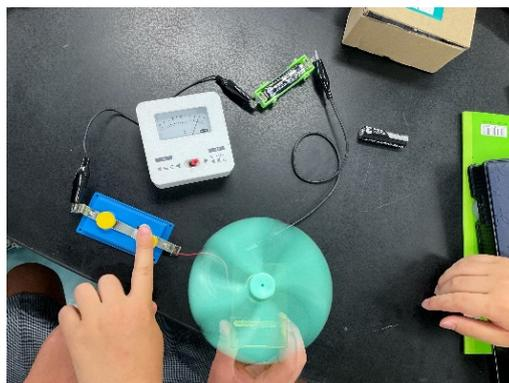
写真6 回路を流れる電流を調べる様子
