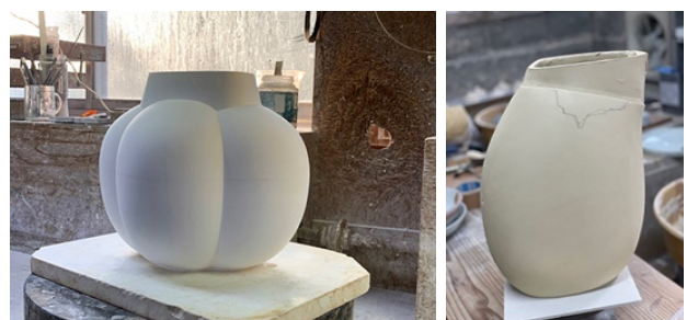
石膏型から取り出した生地(加工前)
