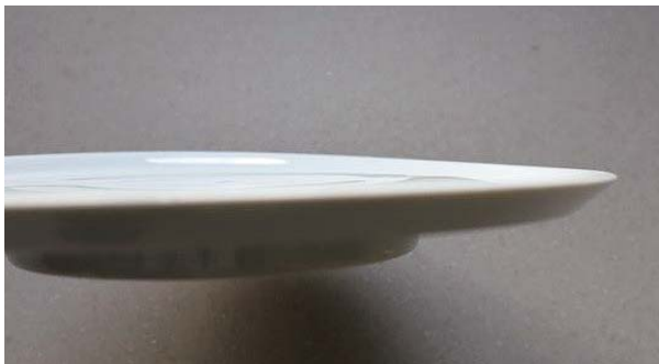
図20 高台を小さくしたことによる焼成変形
