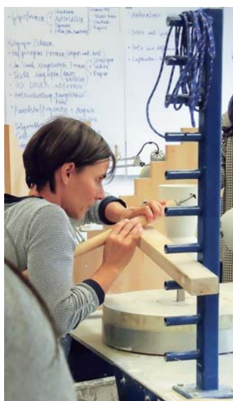
図9 ドイツ式の石膏ロクロ
