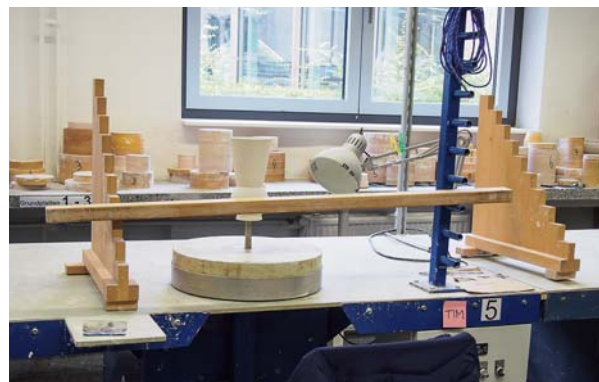
図10 ドイツ式の石膏ロクロ
