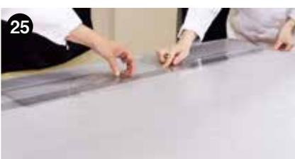
テーブルの全体に穴があいているので、ポリエチレンシートで覆って、シミを抜く箇所だけあけます。
