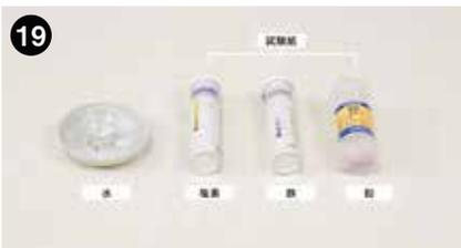
水質検査では、塩素、鉄、鉛などを検知する試験紙を使用します。
