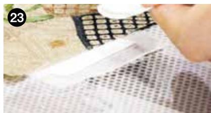
サクシオンテーブルはステンレス製の網を積層させた構造で、テーブルに細かい穴があいています。
