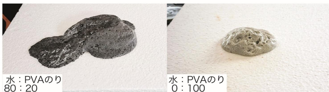
図 11 水:PVA 洗濯のり 80:20(左)の溶岩と、水:PVA 洗濯のり 0:100(右)の溶岩モデル
