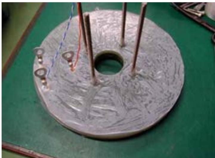
図 3.7 試作した酸化物超電導コイル
