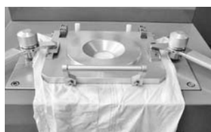
写真1 KES-F8-AP1 通気性試験機
