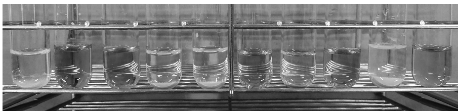
図2-1. 銅 (Ⅱ) 化合物の溶解性 (陰イオンは左から, シュウ酸, ギ酸, 塩化物, クエン酸, リン酸, 硝酸, 水酸化物, グルコン酸, 炭酸, 酢酸)
