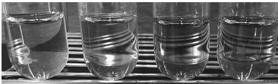
図3-1. 鉄 (Ⅲ) 化合物の溶解性 (陰イオンは左から, クエン酸, 硝酸, ニリン酸, 塩化物)
