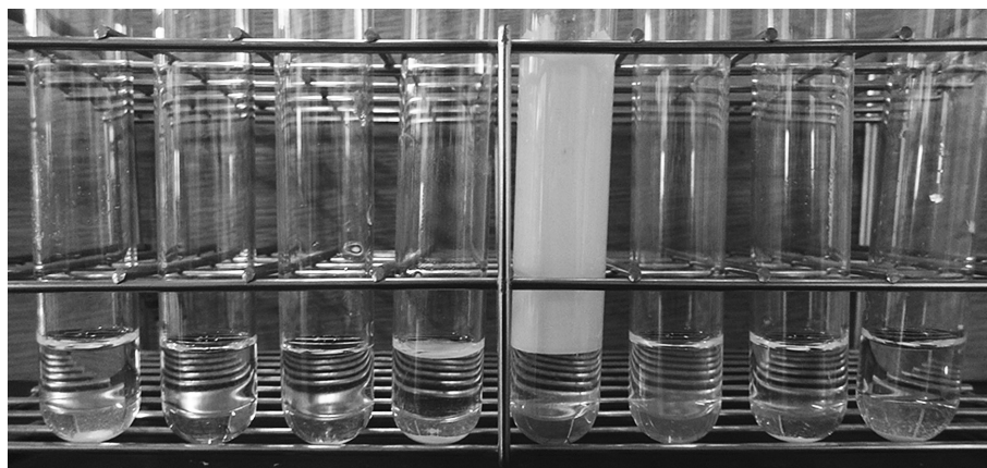
図1. 鉛化合物の溶解性(陰イオンは左から, クエン酸, 硝酸, チオシアン酸, フッ化物, ステアリン酸, 酢酸, 塩化物, ギ酸)
