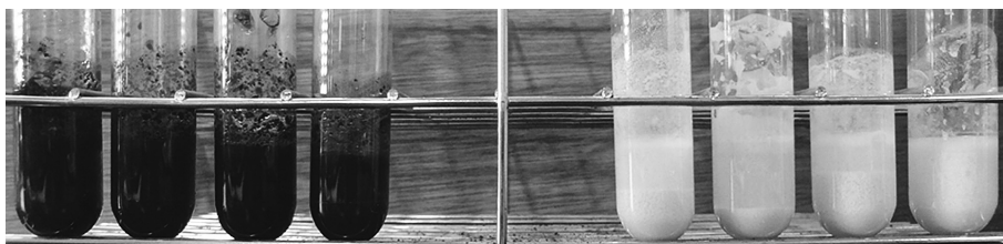
図5. 左は \text{Cu}^{2+} イオン (陰イオンは左から, 硝酸, 塩化物, ギ酸, 硫酸), 右4つはカドミウムイオン (陰イオンは左から, 硝酸, 硫酸, 塩化物, 臭化物) の沈殿
