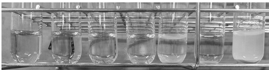
図4-1. ニッケル化合物の溶解性 (陰イオンは左から, 塩化物, 酢酸, 臭化物, ギ酸, 水酸化物, フッ化物, 炭酸)
