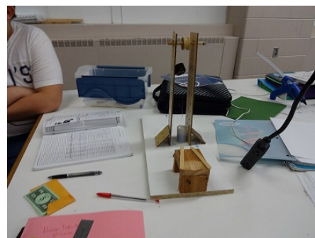
図7 部品として輪軸を用いる様子
