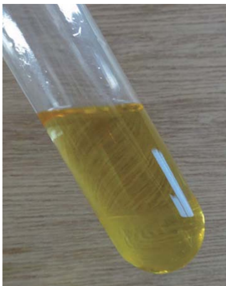
図21 反応終了後には精製油（上層）とグリセリン層（下層）が分離して二層になる。
