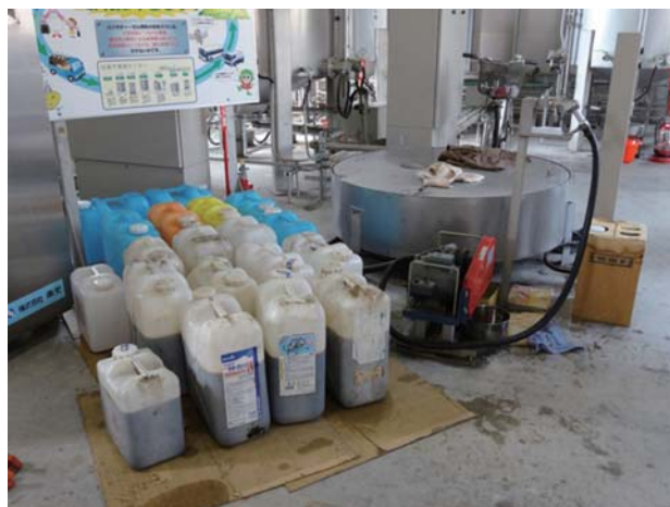
図14 グリセリンはグリセリン取出しタンクから ポリ容器に移されて運び出され、他施設において 肥料として再生される
