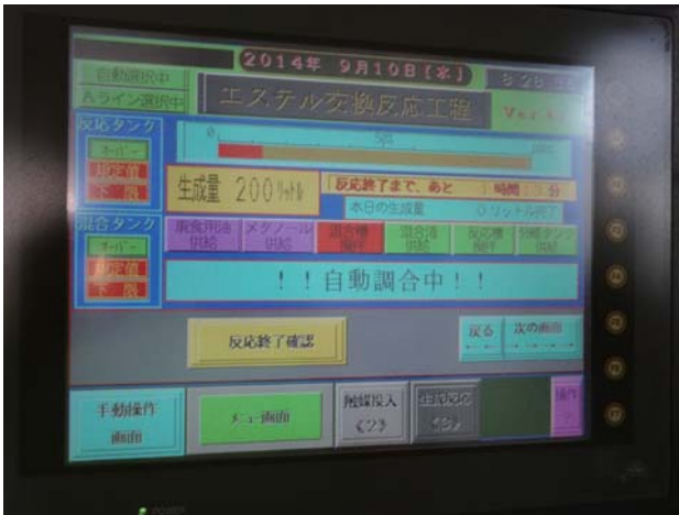
図8 軽油代替燃料化装置に表示されたエステル交換反応工程を制御するための画面
