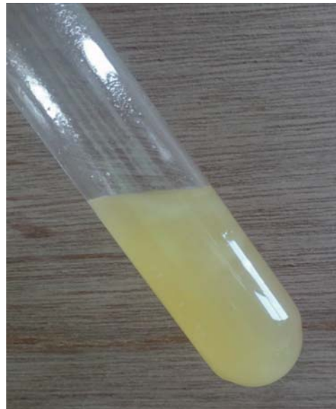
図20 反応液を良く振ると懸濁する（メタノール性 KOHと食用油は混合しにくい）
