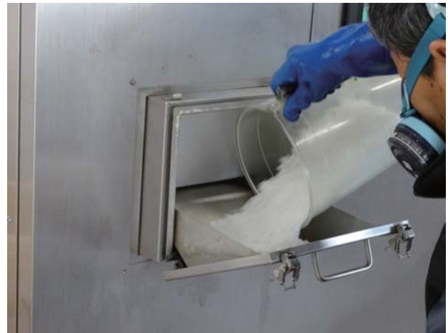
図6 メタノールにKOHを投入して混合液とする (内部のタンクにはすでにメタノールが入っている)
