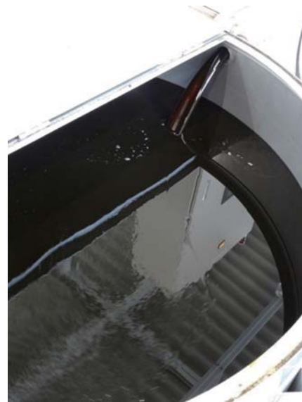
図11 グリセリン分離タンクからグリセリン取出シタンクへの排出（色は暗褐色を呈する）
