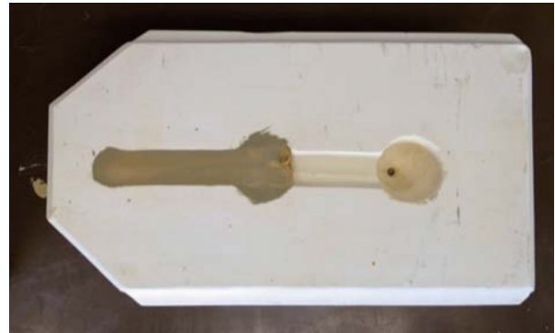
図21 鑄込み後のパイパスの状態
