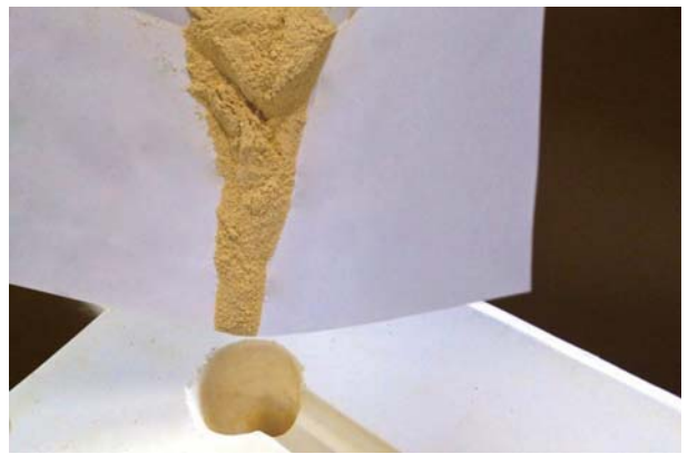
図27 細かめものを鋳込み口から石膏型に振り入れる様子
