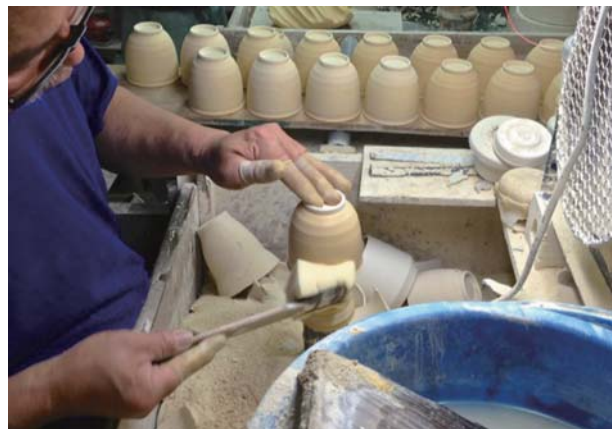
図11 仕上げの様子
