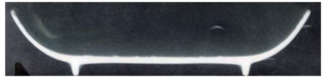
図8 焼き上がり現物切断面 （ダイヤモンドカッターによる）
