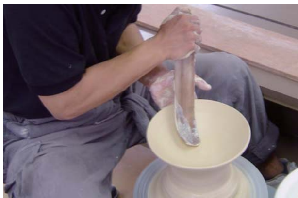
図3 水挽きロクロ成形時
