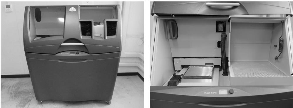
図1 導入した3Dプリンタとその内部
