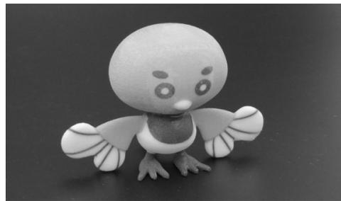
図3 3Dプリンタで出力した造形物
