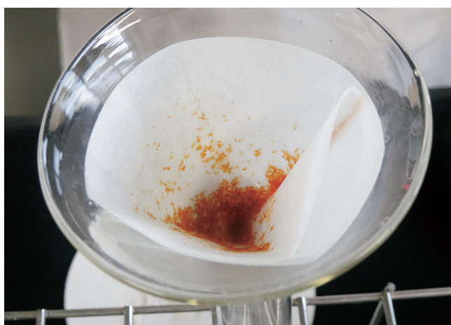
写真17. 水酸化鉄(III)の沈殿をろ過する
