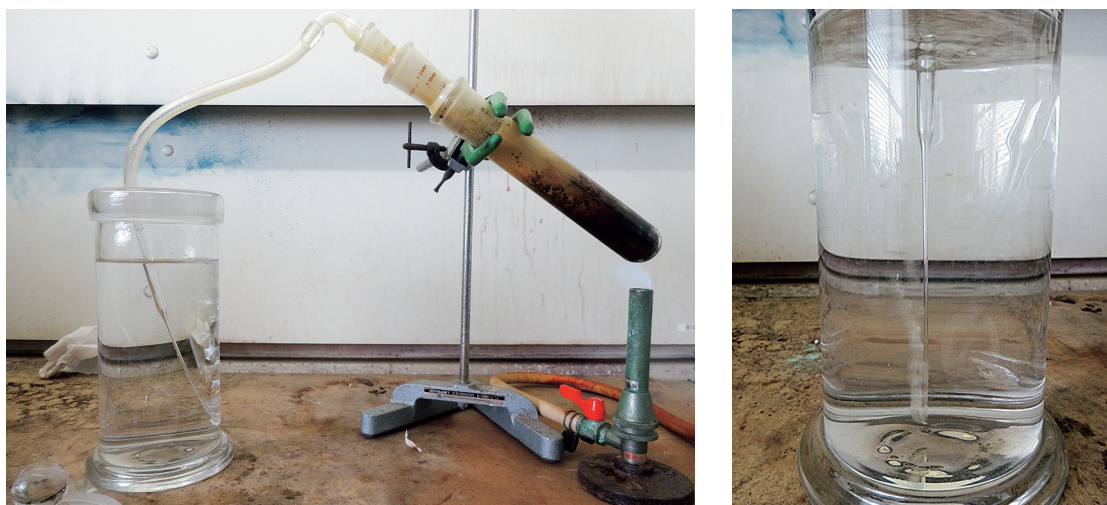
写真1. 固形硫化水素を加熱して硫化水素ガス ( \text{H}_2\text{S} ) を発生させる (左)、 右はピペット先端から発生する気泡
