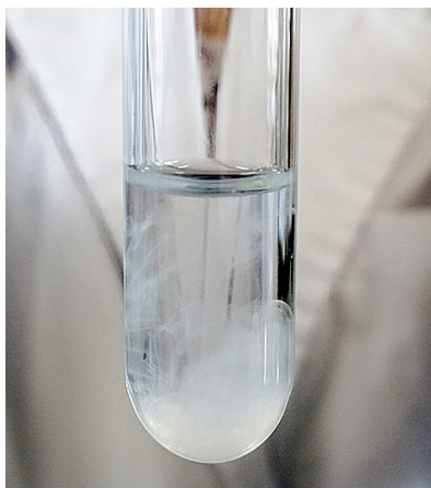
写真18. 炭酸バリウムの白色沈殿
