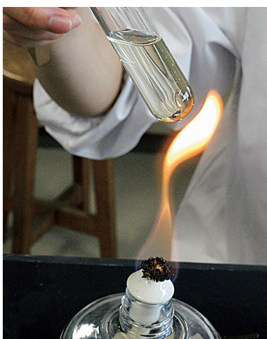
写真10. 残留している硫化水素ガスをアルコールランプにより揮散除去する
