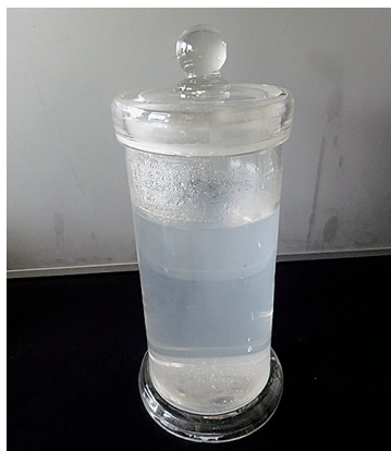
写真5. 数日間放置しておくこと次第に白濁していく。 (蓋は水封してあり。 \text{H}_2\text{S} ガスが揮散しないようにしている)
