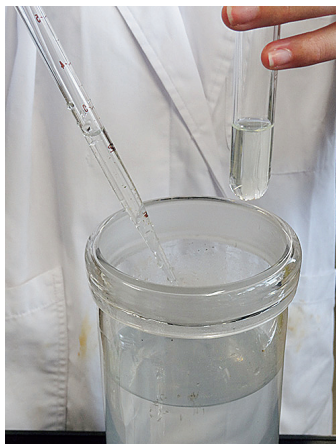
写真4. 金属イオン混合溶液に硫化水素水溶液を滴下する
