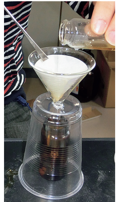
写真8. 簡易ろ過装置
