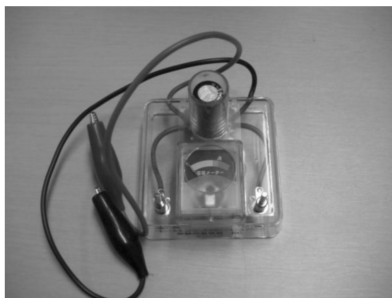
図6 実験の際に用いたメータ付コンデンサー（ヤガミ・51707・実験用蓄電器）
