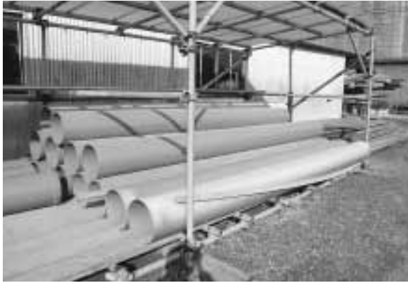
写真 2 実験で用いた塩化ビニル管 (呼び径300mm, 肉厚 8 mm)
