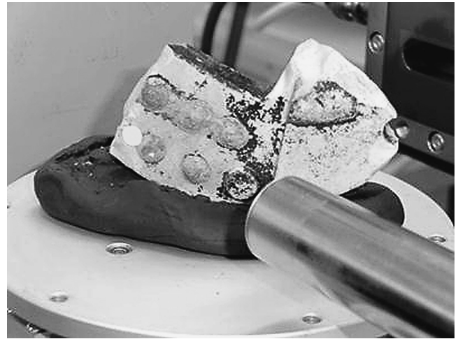
図 4. 白い磁器に銅が埋め込まれた製品
