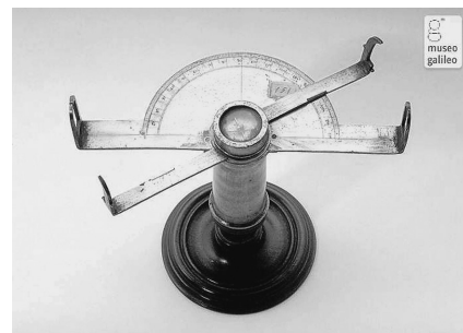
図-8. (左)規矩元器と(下)グラフォメートル
