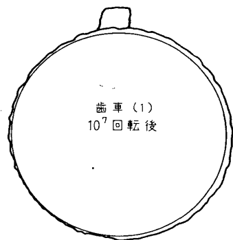
図 5 鋳鉄歯車の負荷運転後のかみあい精度 (和栗式試験機による)
