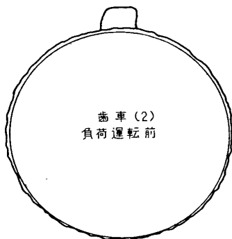
図8 520 H_B の NiCrMo 鋼歯車を超硬ホブで仕上げたままの精度
