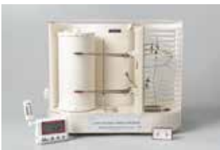
Fig. 11.3 Ջերմաստիճանի և խոնավության ավտոմատ չափիչ, տվյալների գրանցիչ
