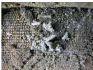
Fig. 13.2 Բրդյա բազկաթուղի նստատեղ-հագուստի ցեցից հասցված վնաս
