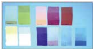
Fig. 13.9 Աստիճանական ֆոտոսպիտակեցումից հետո, ուլտրամանուշակագույն ճառագայթներով լուսանկարում Լինում են դեպքեր, երբ լույսի աղբյուրը փոխելու արդյունքում գունաթափումը ավելի ակնհայտ է լինում
