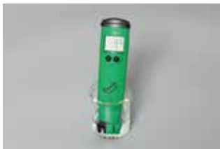
Fig. 18.6 էլեկտրոդը ջրային լուծույթի մեջ ընկղմելով pH-ի չափումը
