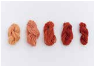
Fig. 8.32 Թելերը 1 ժամ, 3 ժամ, 5 ժամ, 1 օր, 3 օր հետո Ուտիճ նյութով մշակված բերլ քրջում են ներկալուծույթում և ժամանակային տարբերությամբ դուրս հանում
