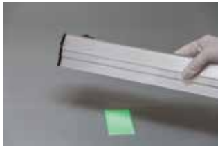
Fig. 10.14 Դիտել անհրաժեշտ հատվածը 245-365 նմ միջակայքով ուլտրամանուշակագույն լամպով
