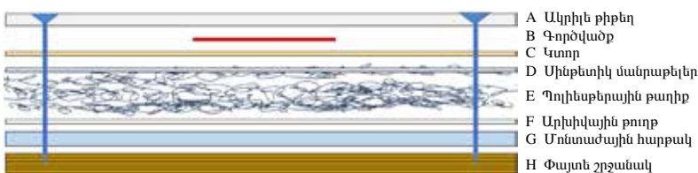
Fig. 11.45 Ճնշման միջոցով մոնտաժման լայնակի կտրվածք
