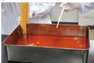
Fig. 8.21 Ներկալուծույթը դարձնում են թթվային և ներկում մանրաթելերը
