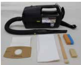
Fig. 16.1 HEPA ֆիլտրով փոշեկուլ, պահեստային տոպրակ, միկրոֆիբրա կտոր, խոզանակ, լատեքսային սպունգ
