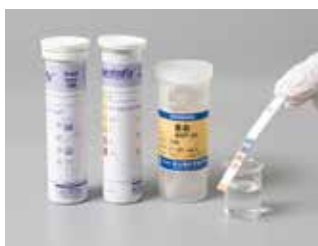
Fig. 18.3 Օգտագործելով տարբեր փորձարկման թղթեր, ստուգում ենք ջրի որակը
