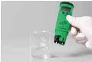
Fig. 18.5 pH չափիչ սարքը էլեկտրոդների միջոցով չափում է ջրածնի իոնի կոնցենտրացիան
