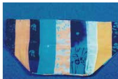
Fig. 3.11 Լուսանկարում ուտրամանուշակագույն լույսի ներքո Կարմիր լուսածորումը սաֆլոր է, դեղինը՝ քրքում: Ներկանյութերի վերլուծությունը կատարված է HPLC-ով:
