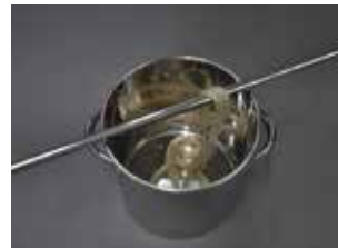
Fig. 8.9 Ներկման ժամանակ ձողը կծիկի միջով անցկացնելու դեպքում թելը չի խճճվի
