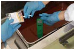
Fig. 8.19 Ներկալուծույթը դարձնում են հիմնային և արտազատում գունանյութը
