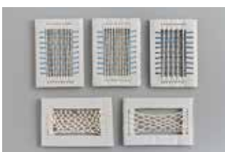
Fig. 4.14 Եթե պատրաստենք մոդել, ավելի լավ կհասկանանք կտորը կազմող տարրերի (թելերի) միջև փոխազդեցությունը
