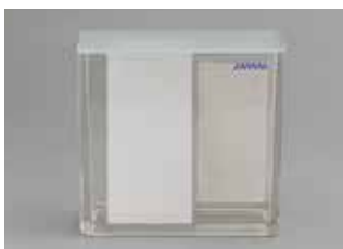
Fig. 10.10 Ծծան թուղթը տեղադրել խցիկի մեջ, լցնել գոլորշիով և լվանալ թիթեղը
