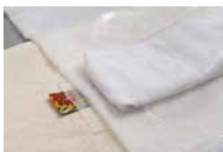
Fig. 14.8 Կոնտակտային խոնավացման եղանակ, Sympatex®-ի վրա դրվել է թաց շղարշ և կիրառվել ջրային գոլորշի:
