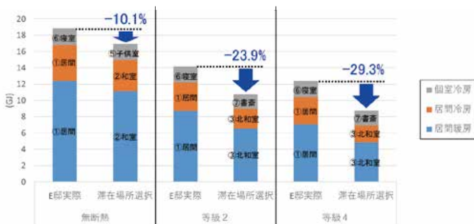
図5 負荷が最小の部屋を滞在場所として選択した場合の年間暖冷房負荷の削減効果
