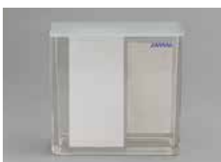
Fig. 10.10 チャンバー内にろ紙を入れて溶媒蒸気で満たし、プレートを洗う
