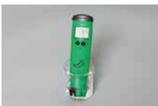
Fig. 18.6 水溶液に電極を浸してpHを測定する
