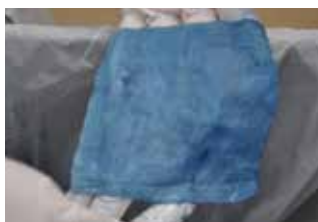
Fig. 8.52 インジゴ色素が空気酸化して発色する
