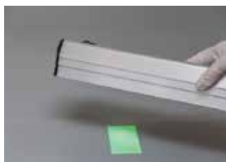
Fig. 10.14 245nm と365nmの切り替えがある紫外線ランプでスポットを観察する
