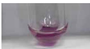
Fig.9.13 コチニール染色布+アンモニア (pH12) 変化あり
