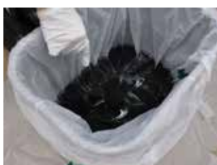
Fig. 8.50 アルカリ水溶液中で還元剤を加え、インジゴ色素を還元する
