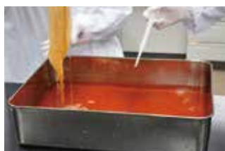
Fig. 8.21 酸性に調整して繊維を染色する
