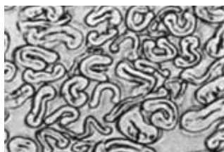
Fig.5.9 綿の断面 中央部に空洞のルーメンがある (AATCC)
