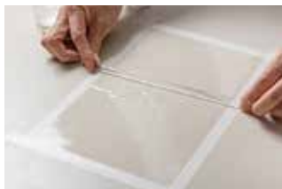
Fig. 24.4 接着フィルムの厚さはマスキングテープを重ねて調節し、ガラス棒で接着剤を伸ばす
