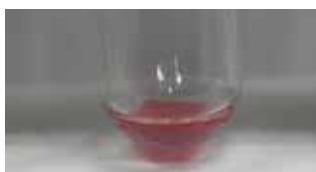
Fig.9.9 セイヨウアカネ染色布+アンモニア(pH12) 変化あり
