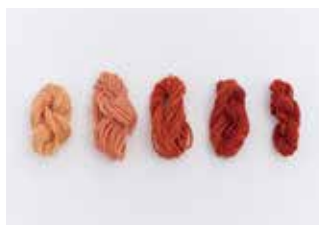
Fig. 8.32 1、3、5時間、1日、3日後媒染した毛を染色液に浸して各時間ごとに取り出す
