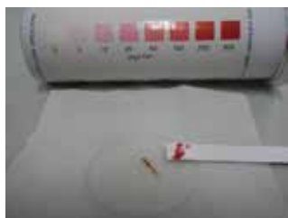
Fig. 20.3 鉄試験紙を使った鉄シミの確認
