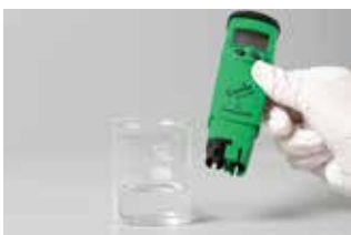
Fig. 18.5 pH測定器は電極で水素イオン濃度を測定
