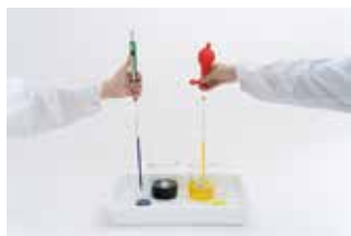
Fig. 25.13 ピペットで染料溶液を計量する
