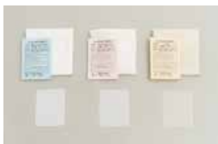
Fig. 8.5 染色試験用白布 綿、絹、羊毛 (JIS L 0803)
