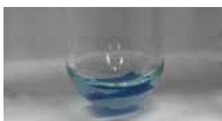
Fig.9.10 インジゴ染色布+酢酸(pH2) 変化あり
