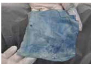
Fig. 8.51 還元された透明なインジゴ色素が繊維に吸収される
