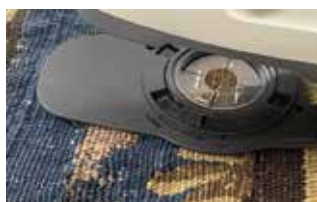
Fig. 9.4 タペストリーの色系の表面を測色する
