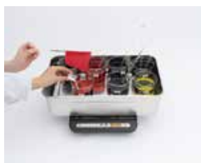
Fig. 25.26 助剤を入れ、加熱しながら布をよくかき回す
