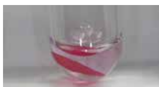
Fig.9.11 コチニール染色布+酢酸(pH2) 変化あり
