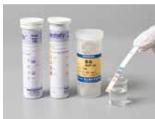
Fig. 18.3 各種試験紙による水質検査
