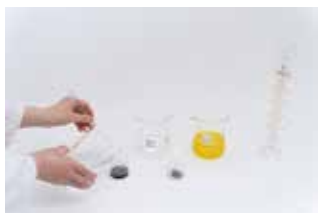
Fig. 25.7 水で染料を溶解する
