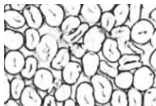
Fig.5.10 マルセル化した綿の断面は丸い形状である (AATCC)
