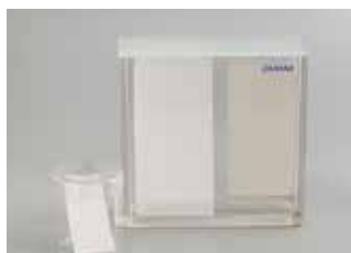
Fig. 10.13 分離チャンバーの底に展開溶媒を約5mm入れ、容器の上部に蒸気がくるようにろ紙を入れる TLCプレートを内部に立てかけ、蓋をして展開する
