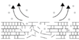
Fig.14.5 劣化した繊維は分解しているため、水が入ると膨潤せずに崩れる
