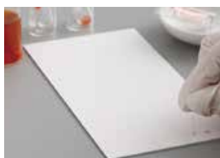
Fig. 10.12 細いガラスピペットでプレートにスポットする
