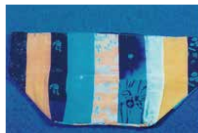
Fig. 3.11 紫外線反射撮影 赤い蛍光色はベニバナ、黄色ウコンである。染料は HPLC で分析済み
