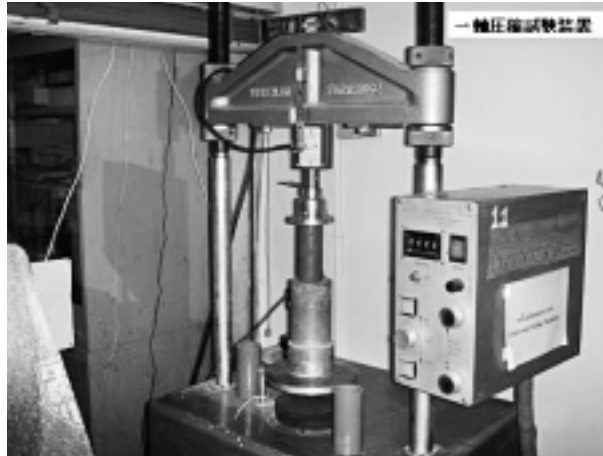
写真5 一軸圧縮試験の実施状況
