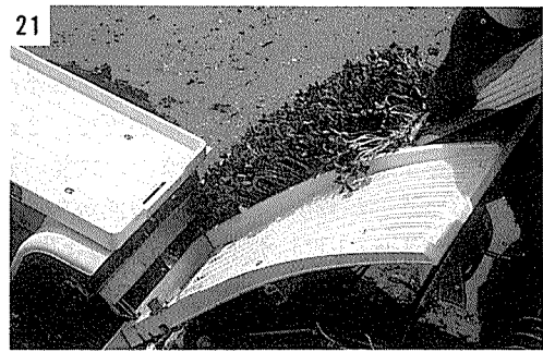
写真-21 田植機に装着された苗受け板（幅5cm、ブリキ製）
