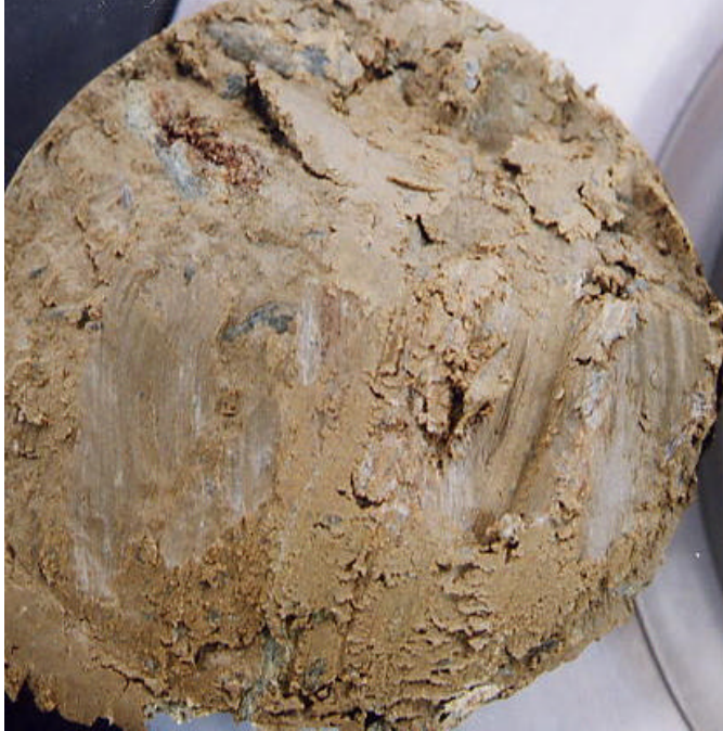
図5. 32 BV14-3Hすべり面に見る光沢の様子
