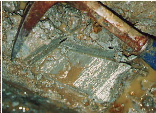
図4. 28 蟹ヶ沢 3すべり面状況（ \theta=11.79^\circ ）
