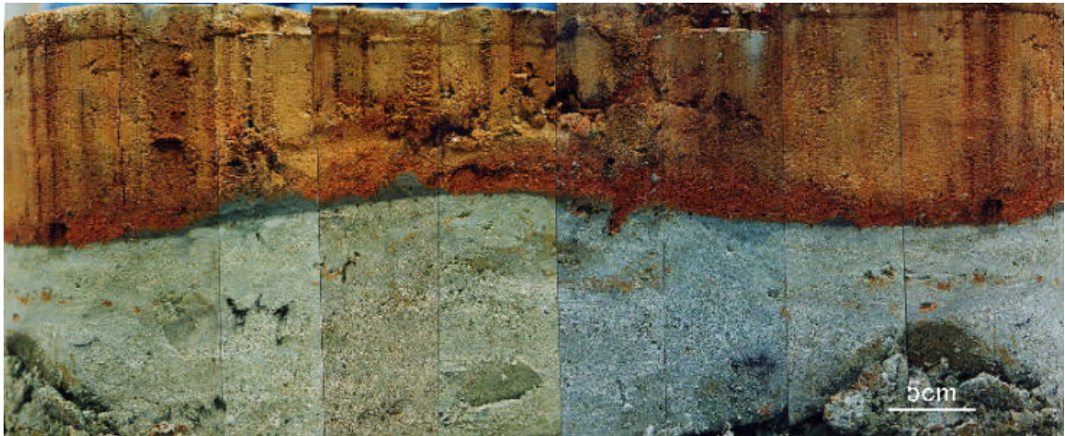
図6. 1 山の内すべり面の産状 (円柱状供試体の全周囲断面状況)
