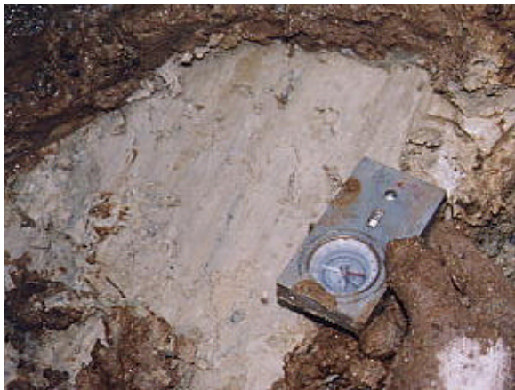
図4. 27 円川原すべり面状況（ \theta=21.15^\circ ）
