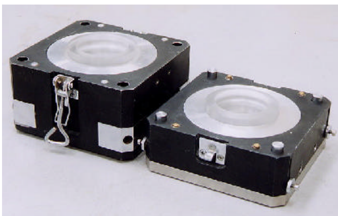
図7. 1 60mm仕様試験機のせん断箱状況
