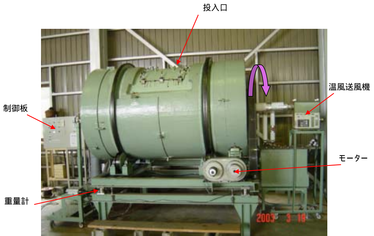
写真 4-1 ドラム回転式無害化处理機
