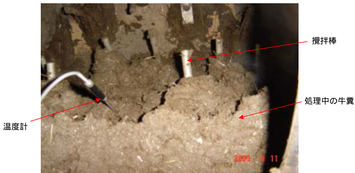
写真4-2 無害化処理機内部の様子
